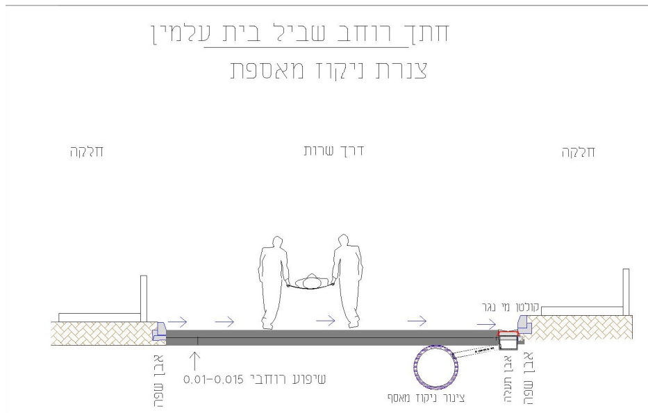
תרשים 3.3 – מערכת ניקוז תת קרקעית.
